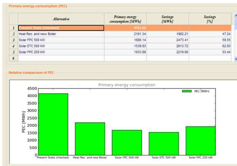
Фиг. 37: Сравнение на сегашното състояние на потребление на първична енергия, и потенциала за намаляване на емисиите, с различни мерките за енергийна ефективност. Всички предложения за слънчеви колектори се основават на алтернативата "топлинно възстановяване" и включват също така и възстановяване на топлоенергията и подновяване на котела.
